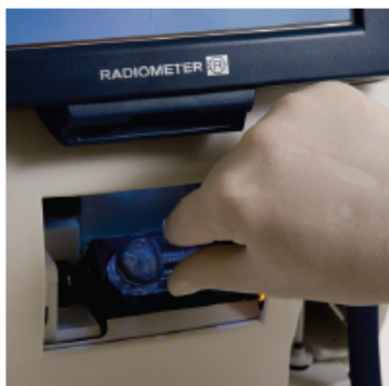
Figur 9: Placering av den nya sensorkassetten i instrumentet
