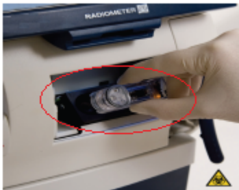
Figur 8: Byte av sensorkassett.
